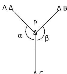
已知 A, B, C 三點坐標，觀測水平角  $\alpha$  及  $\beta$  以求 P 點坐標，
