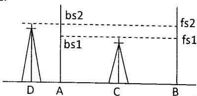
示意如圖，以定樁法檢校某自動水準儀
