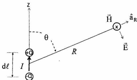
Fig. 2 A Hertzian dipole
