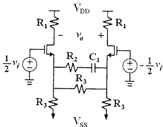
16. 分析下圖之電路。假設所有 MOSFETs 皆工作於飽和區，忽略通道調變效應與基底效應。假設電晶體之  $\mu_n C_{ox} = 1 \text{ mA/V}^2$ ， $(W/L)_1 = (W/L)_2 = 8$ ，Threshold Voltage 分別為  $V_{t1} = 0.6 \text{ V}$ ， $V_{t2} = 0.5 \text{ V}$ ，偏壓電流  $I = 1 \text{ mA}$ ， $R_1 = 4 \text{ k}\Omega$ ，若欲使 Input Offset Voltage 為  $0 \text{ V}$ ，試求所需之  $R_2$  電阻值。(請取 3 位有效數字)
