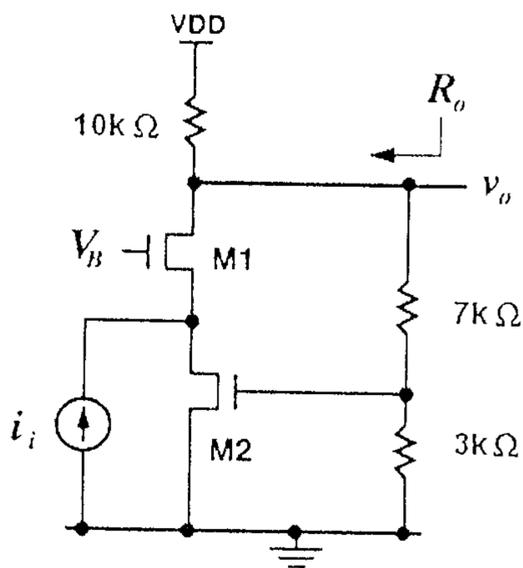
20. 分析如下之電路。假設電晶體皆操作於飽和區，且  $g_{m1} = g_{m2} = g_{m3} = 1 \text{ mA/V}$ ，忽略通道調變效應與基底效應。試求小訊號電壓增益  $\frac{v_o}{v_i}$  之 3dB 頻寬。(單位: rad/sec，請取 3 位有效數字)
