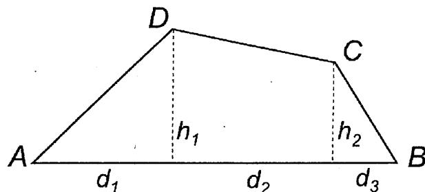
4. 已知 A 點坐標  $(E_A, N_A) = (168500.123 \text{ m}, 2545003.361 \text{ m})$  及 R 點坐標  $(E_R, N_R) = (168734.981 \text{ m}, 2545023.334 \text{ m})$ ，假設 A 及 R 點坐標無誤差，今以全測站儀觀測水平角  $\angle RAB$  得  $\theta = 62^\circ 24'45'' \pm 22''$  及 AB 之水平距離  $L_{AB} = 81.534 \pm 0.004 \text{ m}$ ：(20%)
