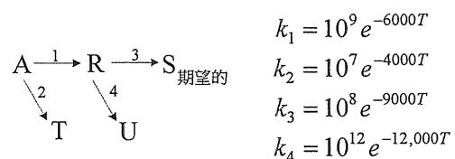
在二個串聯的混合流反應器(MFR)中進行，各反應器可維持在  $10$  和  $90^{\circ}\text{C}$  之間。為了得到最大產率 S，若反應器可保持在不同溫度，試求此二個反應器溫度應為多少？求出此產率。(40 points)
