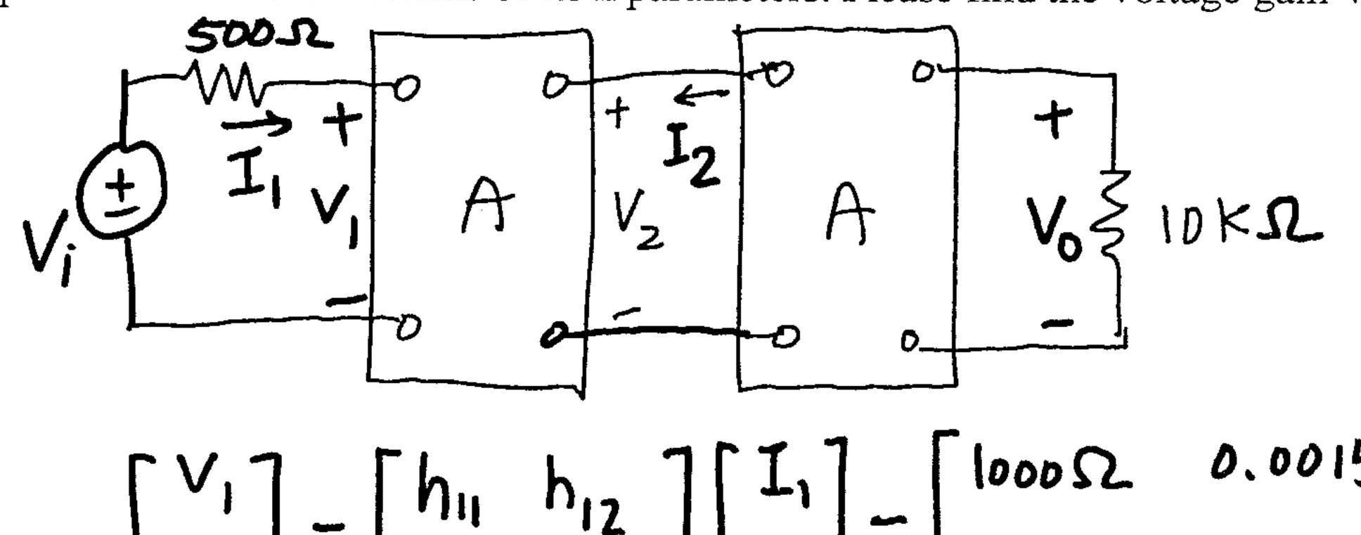
$$\begin{bmatrix} V_1 \\ I_2 \end{bmatrix} = \begin{bmatrix} h_{11} & h_{12} \\ h_{21} & h_{22} \end{bmatrix} \begin{bmatrix} I_1 \\ V_2 \end{bmatrix} = \begin{bmatrix} 1000 \Omega & 0.0015 \\ 100 & 100 \mu S \end{bmatrix} \begin{bmatrix} I_1 \\ V_2 \end{bmatrix}$$
